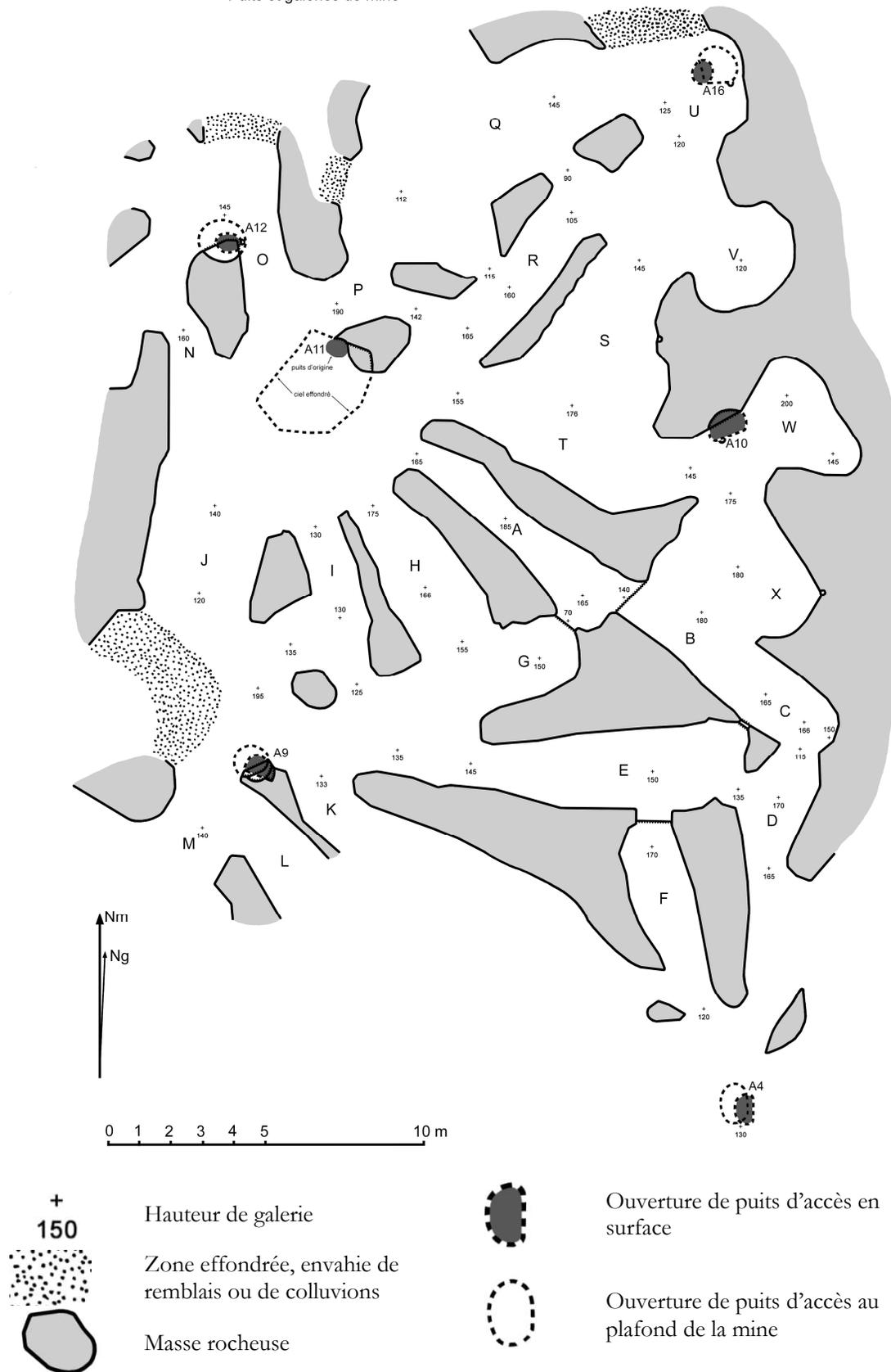
**Fig. 2 : Plan d'une petite partie de la mine de fer de Gounoudoudji, avec puits d'accès et galeries de mine. Commune de Dogbo, département du Couffo dans le Sud du Bénin (J. & L. Triolet, 2018).**
